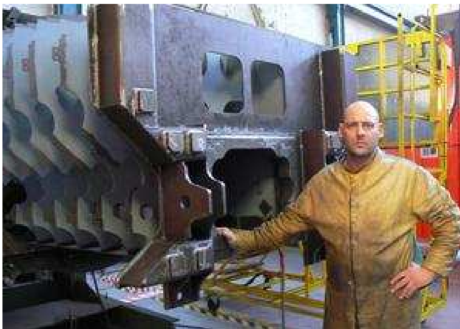
Laurent Chavan, soudeur monteur, construit les absorbeurs d'énergie déformables des trains à grande vitesse. (Photo DNA - A.L.)
