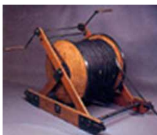
Treuil de mesure de résistivité utilisé à Pechelbronn en 1927.
